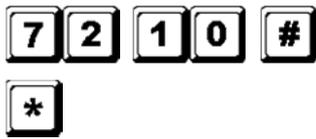
Toetsenbord ingesteld om, na 10 foute codes, gedurende 15 minuten te blokkeren
